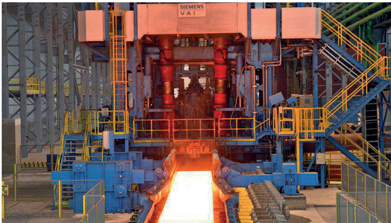
Maszyna ciągłego odlewania stali w krakowskiej hucie. Tak wyglądała, gdy pracowała.
